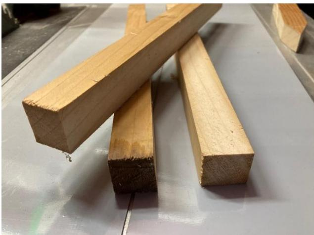
Diese dann an einem Ende mit 17 Grad zuschneiden. Je weniger Grad, umso spitzer die Strahlen. Am besten eine Schablone für einen Mehrfachschnitt machen, damit alle gleich sind.
