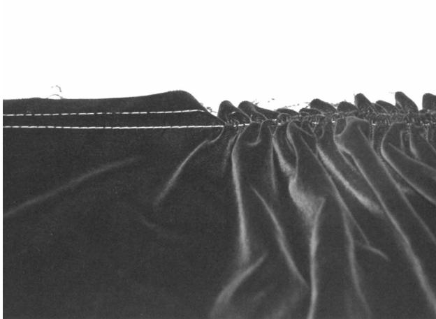
In die Stoffbahn lt. Markierung zwei Reihfäden einziehen und auf die Länge des Außenradius der Passe zusammenziehen.
